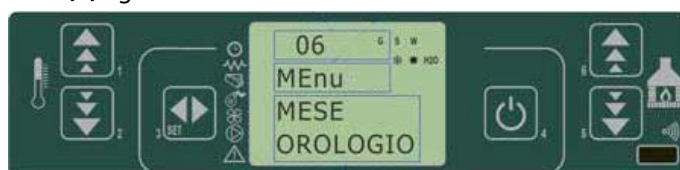
fig. 19 painel de comandos - definição de hora e data
