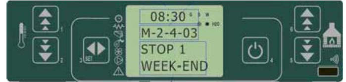
fig. 23 tableau de commande - programmation du week-end
