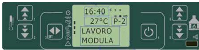
fig. 30 painel de comandos - modular a temperatura definida
