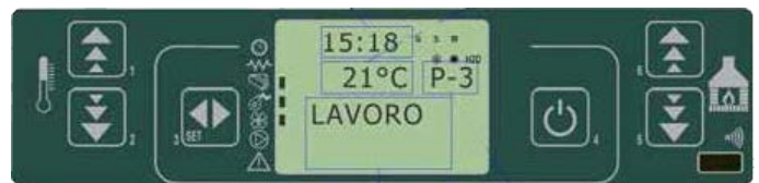
fig. 28 tableau de commande - condition de travail
