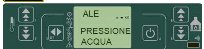
fig. 46 painel de comandos - pressão da água
