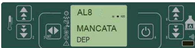
fig. 41 tableau de commande - alarme du pressostat de sécurité de la vis sans fin
