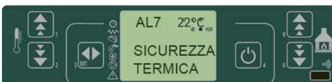
fig. 42 tableau de commande - alarme du thermostat général
