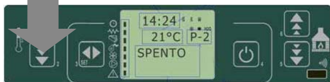
fig. 33 painel de comandos - desligamento
