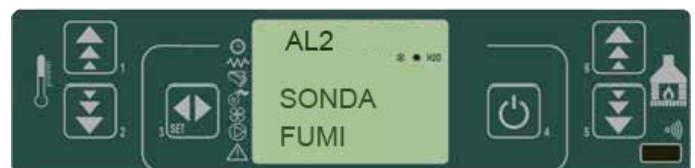
fig. 37 tableau de commande - alarme de la sonde de température des fumées
