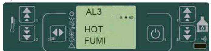
fig. 38 painel de comandos - alarme por sobretenperatura dos fumos
