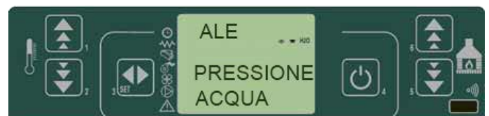
fig. 46 tableau de commande - pression de l'eau
