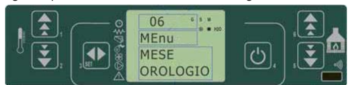
fig. 19 tableau de commande - configuration de l'heure et de la date
