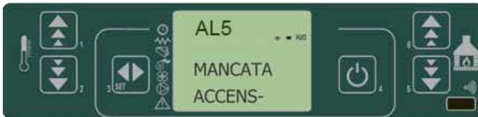
fig. 39 tableau de commande - alarme d'allumage raté
