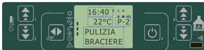
fig. 31 painel de comandos - modalidade limpeza do braseiro
