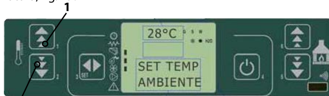
fig. 29 painel de comandos - modificar a temperatura ambiente
