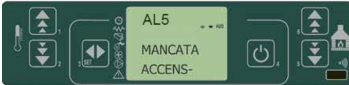
fig. 47 painel de comandos - falha no acendimento dos pellets
