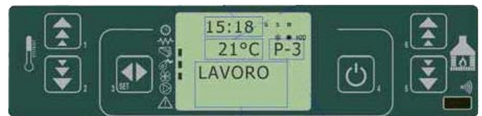
fig. 28 painel de comandos - condição de funcionamento
