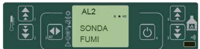
fig. 37 painel de comandos - alarme por sonda de temperatura dos fumos
