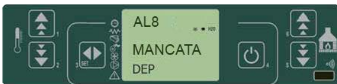
fig. 41 painel de comandos - alarme por pressóstato de segurança da rosca sem-fim
