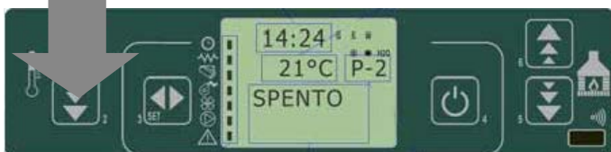
fig. 33 painel de comandos - desligamento
