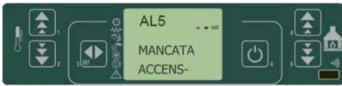
fig. 39 painel de comandos - alarme por falha no acendimento
