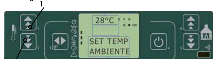
fig. 26 painel de comandos - modificar a temperatura ambiente
