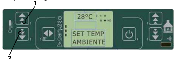
fig. 26 tableau de commande - modification de la température ambiante
