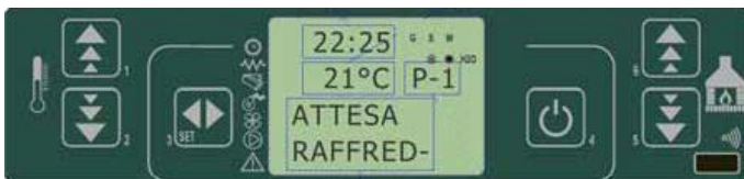
fig. 31 tableau de commande - attente de refroidissement avant de rallumer
