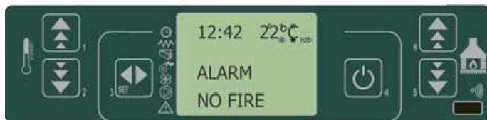
fig. 36 painel de comandos - alarme por desligamento durante funcionamento
