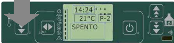
fig. 30 tableau de commande - arrêt
