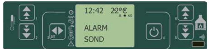
fig. 33 painel de comandos - alarme por sonda de temperatura dos fumos
