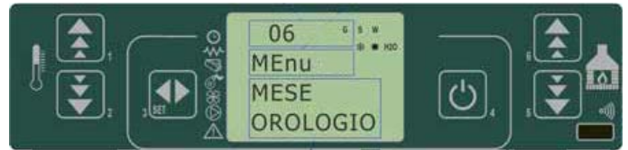
fig. 16 tableau de commande - configuration de l'heure et de la date
