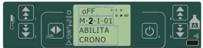
fig. 17 tableau de commande - activation des fonctions du thermostat programmable
