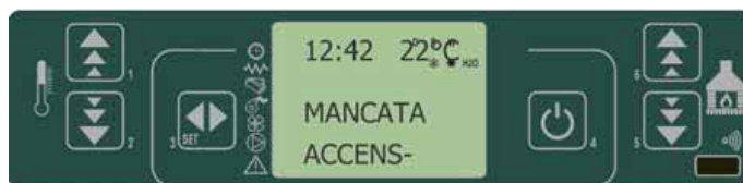
fig. 35 tableau de commande - alarme d'allumage raté
