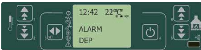
fig. 37 tableau de commande - alarme du pressostat de sécurité de la vis sans fin
