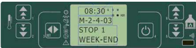
fig. 20 tableau de commande - programmation du week-end
