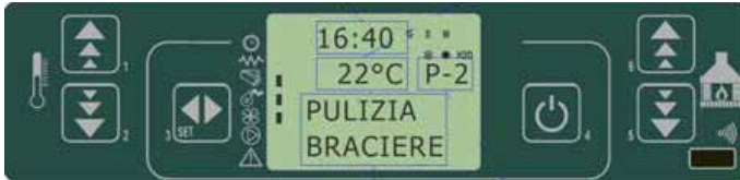
fig. 28 tableau de commande - modalités de nettoyage du brasero
