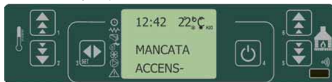
fig. 40 painel de comandos - falha no acendimento dos pellets
