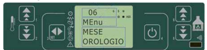
fig. 16 painel de comandos - definição de hora e data
