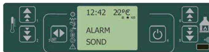
fig. 33 tableau de commande - alarme de la sonde de température des fumées
