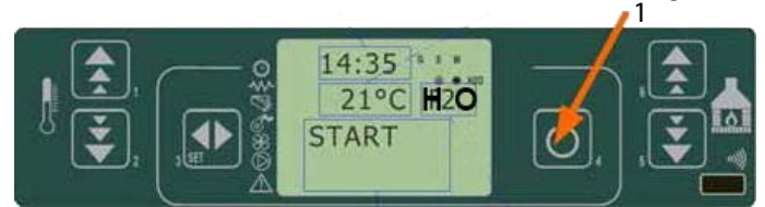
fig. 24 painel de comandos - acendimento
