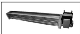
• Os recuperadores DORIS e DIONE estão equipados com ventilação forçada, incorporam 1 ventilador tangencial, com potência de 15W e com um caudal de 100 m<sup>3</sup>/h, ligado em paralelo a um termóstato.
