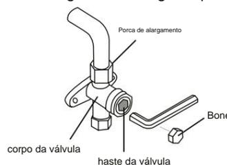
12. Utilizando uma chave hexagonal, abra totalmente as válvulas de alta e baixa pressão.
