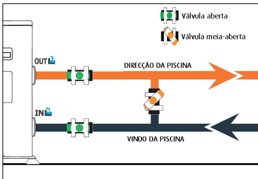
Efetue a ligação da tubagem de PVC as tomadas disponíveis na bomba de calor. A ligação é efetuada mediante um bypass instalado no sistema de filtragem da piscina, após o filtro e antes do sistema de tratamento de água.
