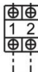
**CONTATO ABERTO:** BOMBA DE CALOR DESLIGADA
