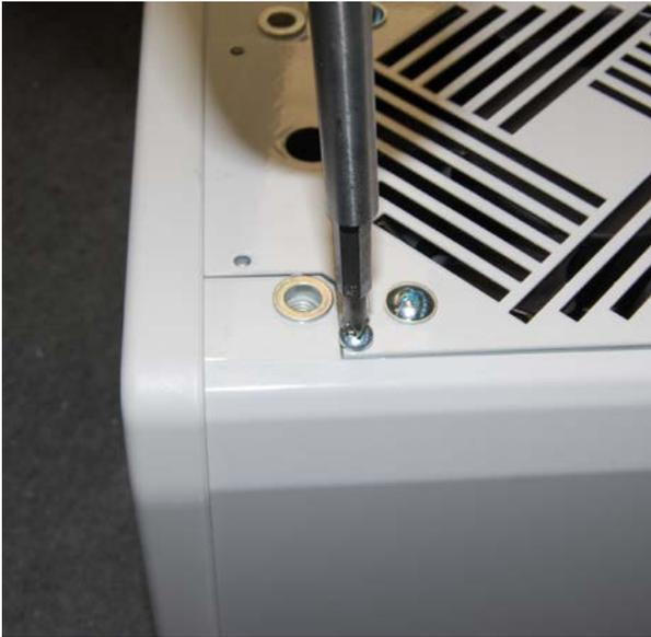
Retire os parafusos que prendem o painel de ventilação e retire este com cuidado.
