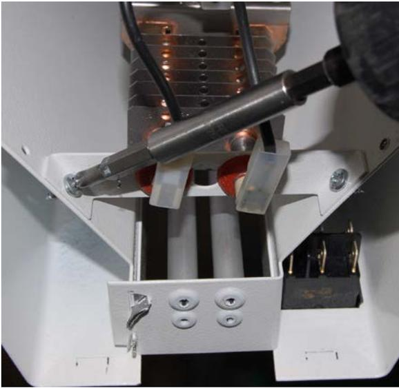
Para sustituir la batería desconectar los cables de conexión y sacar los so
