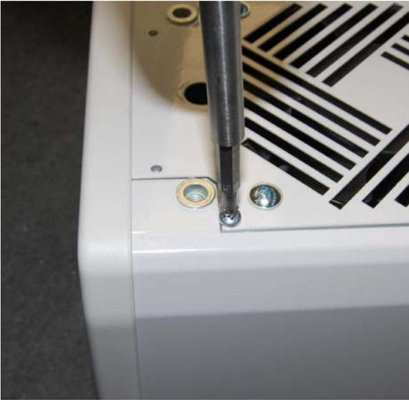
Retire los tornillos que sujetan el tren de ventilación y extraiga este con cuidado.
