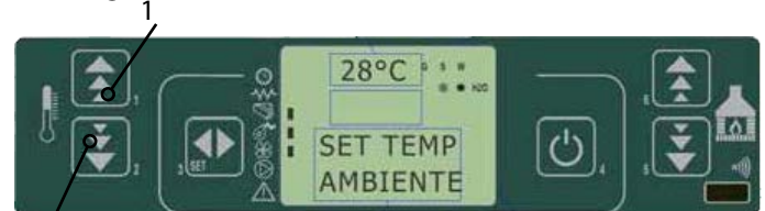
fig. 26 painel de comandos - modificar a temperatura ambiente
