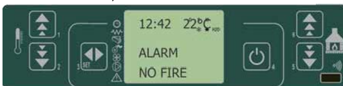
fig. 36 tableau de commande - alarme d'arrêt pendant le travail
