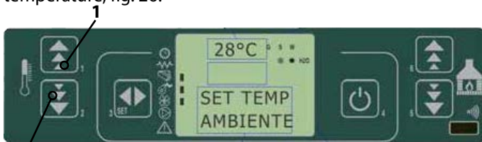
fig. 26 tableau de commande - modification de la température ambiante
