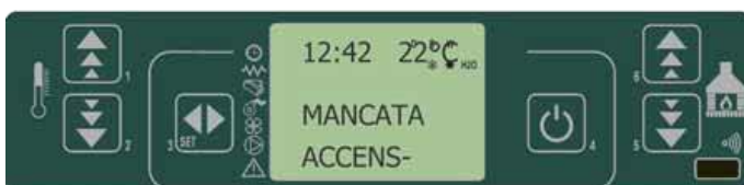
fig. 35 tableau de commande - alarme d'allumage raté
