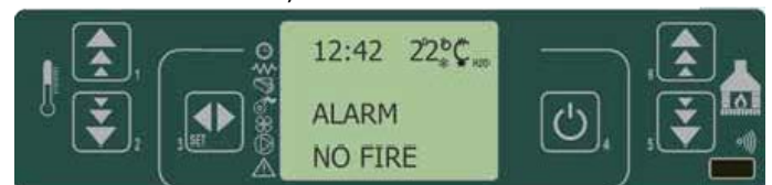
fig. 36 painel de comandos - alarme por desligamento durante funcionamento
