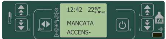
fig. 40 painel de comandos - falha no acendimento dos pellets
