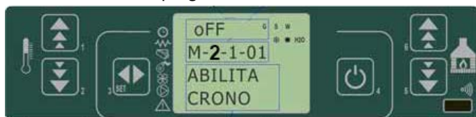
fig. 17 tableau de commande - activation des fonctions du thermostat programmable
