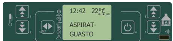
fig. 39 tableau de commande - alarme du ventilateur d'aspiration des fumées
