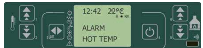
fig. 34 painel de comandos - alarme por sobret emperatura dos fumos
