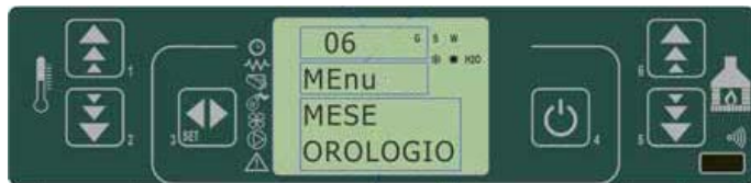
fig. 16 tableau de commande - configuration de l'heure et de la date
