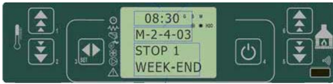
fig. 20 tableau de commande - programmation du week-end
