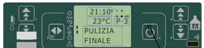
fig. 29 tableau de commande - nettoyage final
