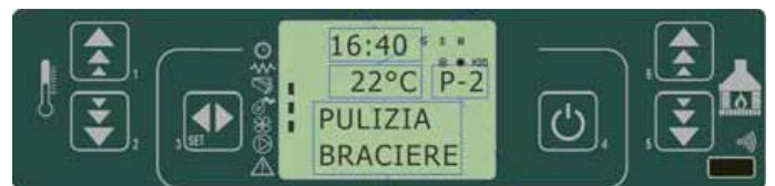
fig. 28 tableau de commande - modalités de nettoyage du brasero
