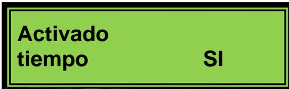
Para activar el tiempo: utilizar las teclas ▲ y ▼, para activar y desactivar el tiempo, cuando está activado, el led verde se enciende. Presionando SET se confirma la orden, y con la tecla ⏻ salimos sin salvar la modificación. Si activamos el temporizador se accede automáticamente a la primera pantalla de programaciones.
