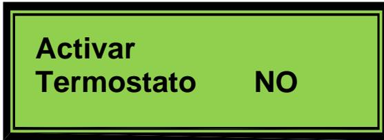
Esta función activa o desactiva el termostato externo con contacto normalmente cerrado (N.C.). La apertura del contacto determina una demanda de calor por parte del ambiente, mientras que con el contacto cerrado se indica que la temperatura ambiente es la deseada. Una vez activado el termostato, la sonda ambiente se deshabilitará automáticamente. Utilizar las teclas ▲ y ▼ para encender o **SI** o **NO**; presione la tecla SET para confirmar o la tecla
