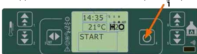
fig. 27 painel de comandos - acendimento
