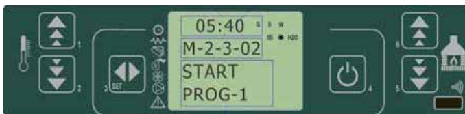
fig. 22 tableau de commande - programmation hebdomadaire
