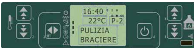
fig. 31 painel de comandos - modalidade limpeza do braseiro
