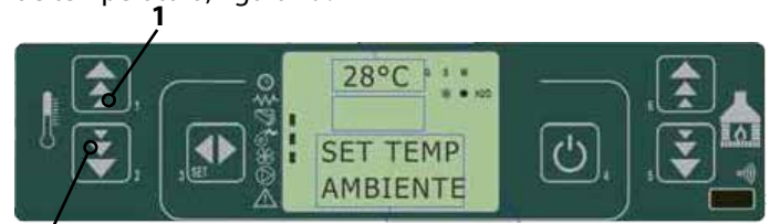
fig. 29 panel de mandos - modificar temperatura ambiente
