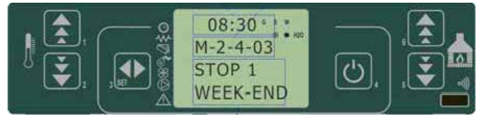
fig. 23 painel de comandos - programação week end
