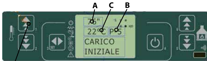
1 fig. 25 panel de mandos - carga inicial de pellet
