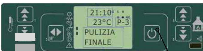
fig. 32 tableau de commande - nettoyage final
