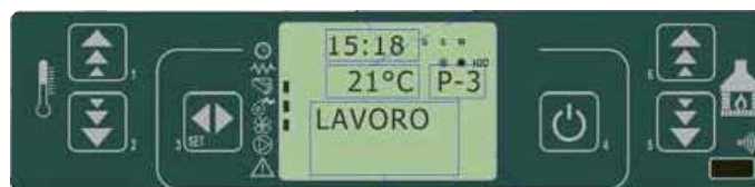
fig. 28 painel de comandos - condição de funcionamento
