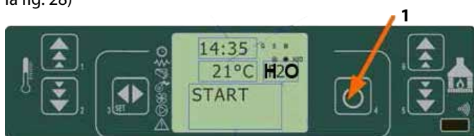
fig. 27 tableau de commande - allumage
