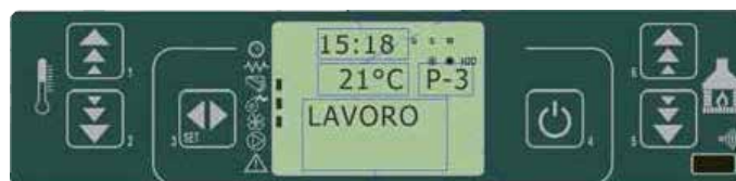
fig. 28 tableau de commande - condition de travail
