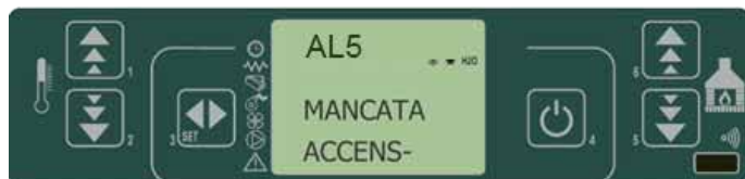
fig. 47 tableau de commande - allumage raté du pellet
