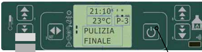
fig. 32 panel de mandos - limpieza final
