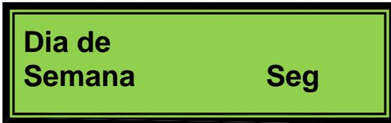
Permite seleccionar o dia da semana: utilizar as teclas ▲ e ▼ para modificar o dia; pressionar SET para confirmar e acceder ao painel de ajustes da hora, ou com a tecla ⏻ para passar ao painel de regulação da hora sem modificar o dia da semana.
