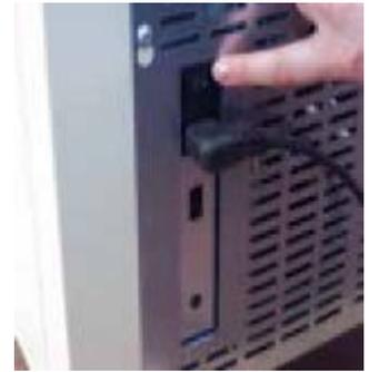
Certifique-se de que o interruptor principal da salamandra esteja em 0 e, em seguida, conecte o cabo de alimentação primeiro atrás da salamandra e, em seguida, a uma tomada eléctrica na parede. O interruptor geral na parede traseira só é ativado quando a salamandra é ligada; caso contrário, é aconselhável remover o cabo de conexão do equipamento.
