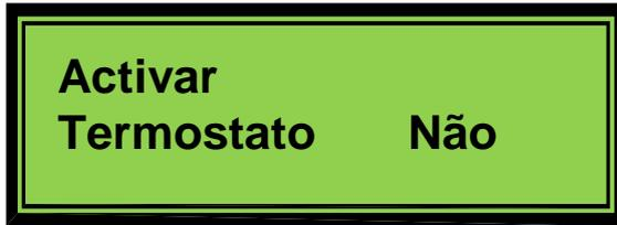
Esta função activa ou desactiva o termostato externo com contacto normalmente fechado (N.F.). A abertura do contacto determina uma demanda de calor pelo ambiente, enquanto que com contacto fechado é indicado que a temperatura ambiente é satisfeita. Quando o termostato estiver ativado, a sonda ambiente será desativada automaticamente. Utilizar las teclas ▲ e ▼ para escolher **SIM** ou **NÃO**; pressione a tecla SET para confirmar ou a
