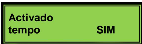
Para activar o tempo: utilizar las teclas ▲ e ▼, para activar e desactivar o tempo, quando está activado, o led verde se acende. Pressionando SET confirma-se a ordem, e com a tecla ⏻ saímos sem guardar as modificações. Se activamos o temporizador accede automaticamente ao primeiro painel de programação.
