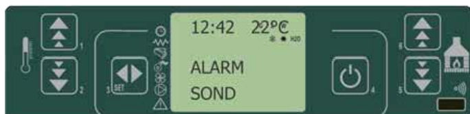
fig. 33 painel de comandos - alarme por sonda de temperatura dos fumos
