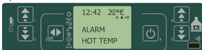
fig. 34 painel de comandos - alarme por sobretemperatura dos fumos
