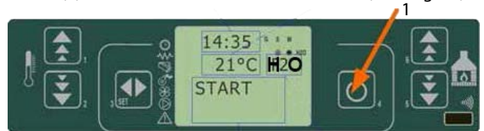
fig. 24 painel de comandos - acendimento
