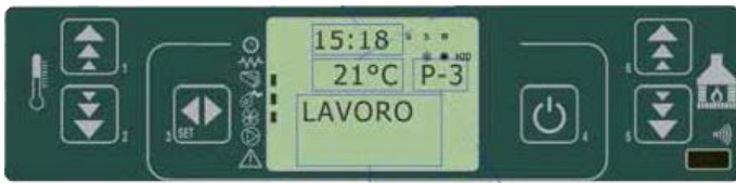
fig. 25 painel de comandos - condição de funcionamento
