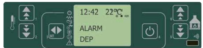
fig. 37 painel de comandos - alarme por pressóstato de segurança da rosca sem-fim
