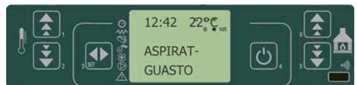
fig. 39 painel de comandos - alarme ventilador de aspiração de fumos
