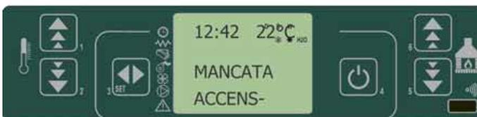
fig. 35 painel de comandos - alarme por falha no acendimento
