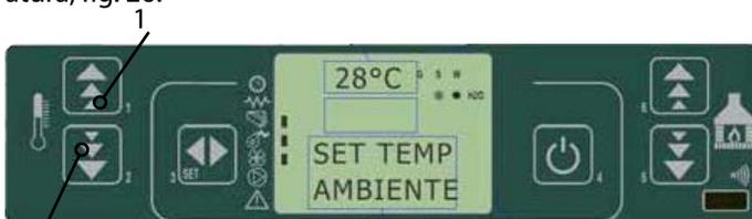
fig. 26 painel de comandos - modificar a temperatura ambiente
