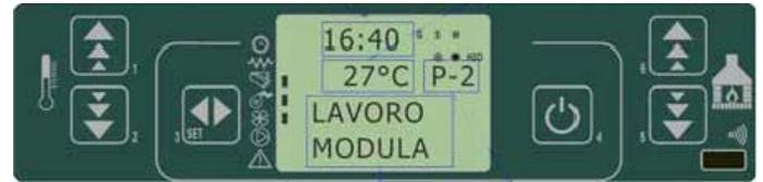
fig. 27 painel de comandos - modular a temperatura definida
