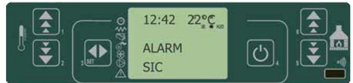
fig. 38 painel de comandos - alarme por termóstato geral
