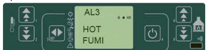
fig. 38 painel de comandos - alarme por sobretemperatura dos fumos
