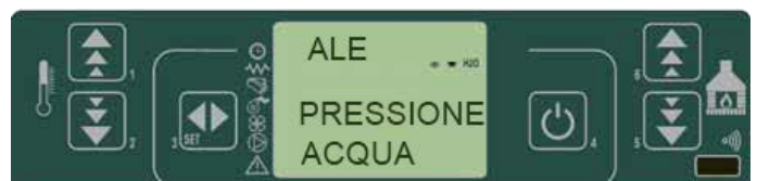
fig. 46 tableau de commande - pression de l'eau
