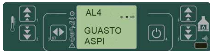
fig. 43 tableau de commande - alarme du ventilateur d'aspiration des fumées
