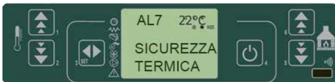
fig. 42 painel de comandos - alarme por termóstato geral
