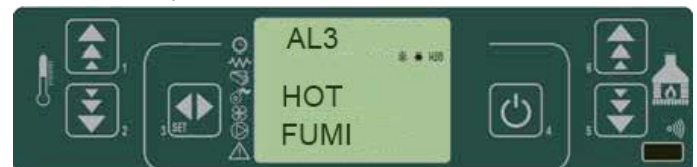
fig. 38 tableau de commande - alarme de surchauffe des fumées
