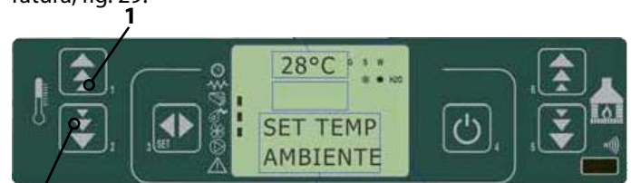
fig. 29 painel de comandos - modificar a temperatura ambiente
