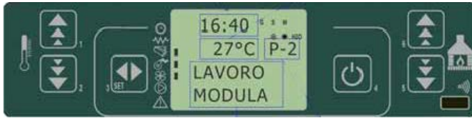
fig. 30 tableau de commande - modulation de la température configurée
