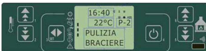
fig. 31 tableau de commande - modalités de nettoyage du brasero
