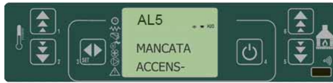
fig. 39 tableau de commande - alarme d'allumage raté
