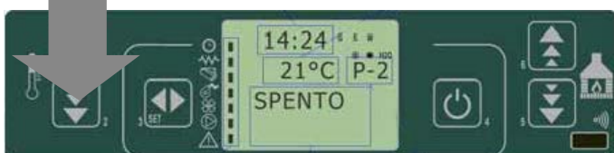
fig. 33 painel de comandos - desligamento
