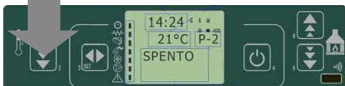
fig. 33 tableau de commande - arrêt
