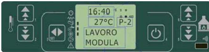
fig. 30 painel de comandos - modular a temperatura definida
