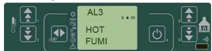
fig. 38 tableau de commande - alarme de surchauffe des fumées
