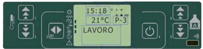
fig. 28 tableau de commande - condition de travail
