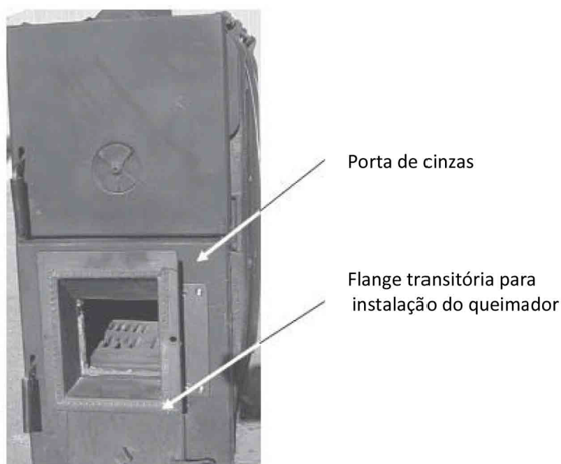
Fig. n.º 14 A porta inferior com a flange do queimador
