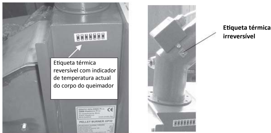
Fig. n.º 7 Posicionamento das etiquetas térmicas no queimador
