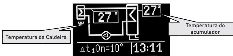
Neste modo, a água é aquecida apenas pela instalação da caldeira. Após se ligar a bomba de circulação, tal é apresentado no ecrã. O modo de aquecimento caldeira é adequado para utilizar quando a energia solar é insuficiente para fornecer a quantidade de água quente necessária.
