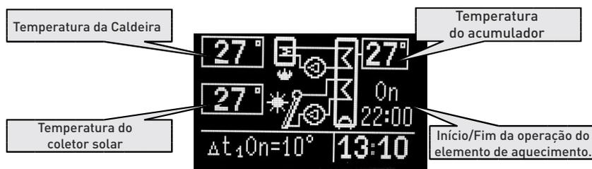
Este modo é adequado em casos em que a energia da instalação solar e de aquecimento é insuficiente para aquecer a água e permite usar a energia noturna mais económica.
