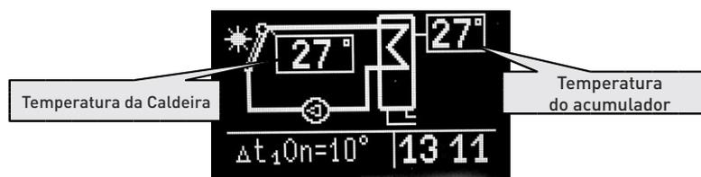
Neste modo, a água é aquecida apenas pela instalação do coletor solar. Após se ligar a bomba de circulação do sistema solar, tal é apresentado no ecrã.
