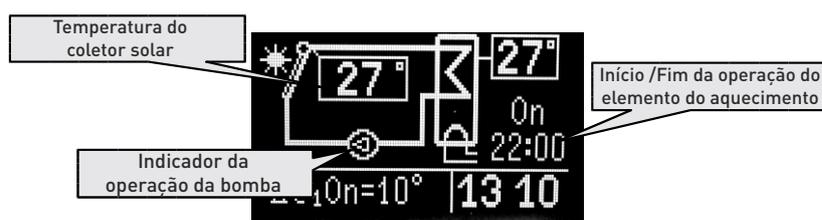
Este modo é adequado em casos em que a energia solar é insuficiente para aquecer a água e permite a utilização de energia noturna mais económica.
