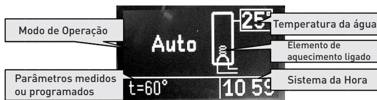
Neste modo, a água é aquecida apenas pelo elemento de aquecimento elétrico do acumulador mantendo a temperatura preliminar programada. O elemento de aquecimento ligado é visualizado no ecrã com “balões” em movimento sobre o elemento de aquecimento em causa.
