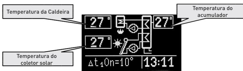
Este modo é adequado em casos de aquecimento de água por um coletor solar assim como por caldeira. O Modo Combinado 3 assegura a eficiência da utilização da energia solar e da caldeira para manutenção da temperatura do acumulador.
