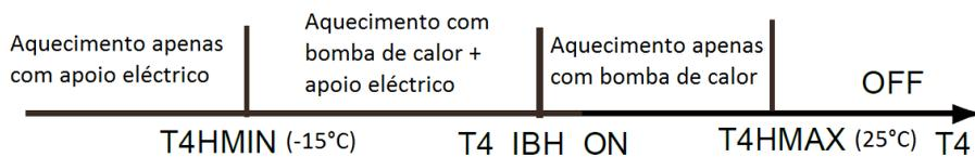
**dT1\_IBH\_ON** – Diferença de temperatura entre T1S e T1 para iniciar a resistência de apoio. Apenas quando  $T1 < T1S - dT1\_IBH\_ON$  é que o apoio é activado. Se for instalado um segundo apoio, este apenas activa quando a diferença de temperatura entre TS1 e T1 é superior a  $dT1\_AHS\_ON + 2$
